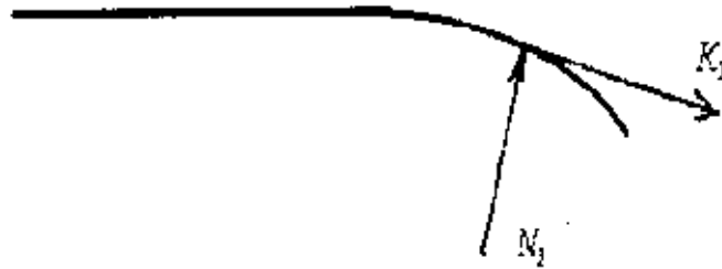
Рис. 4 - Схема действия сил на тележки конвейерного поезда на закруглении пути
